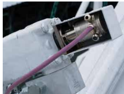
Энкодер для линейного измерения расстояния на тоннелепроходческой машине.
