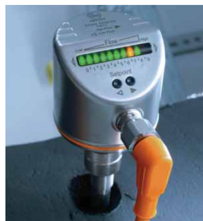
Датчик потока с адаптером для контроля малых расходов.
